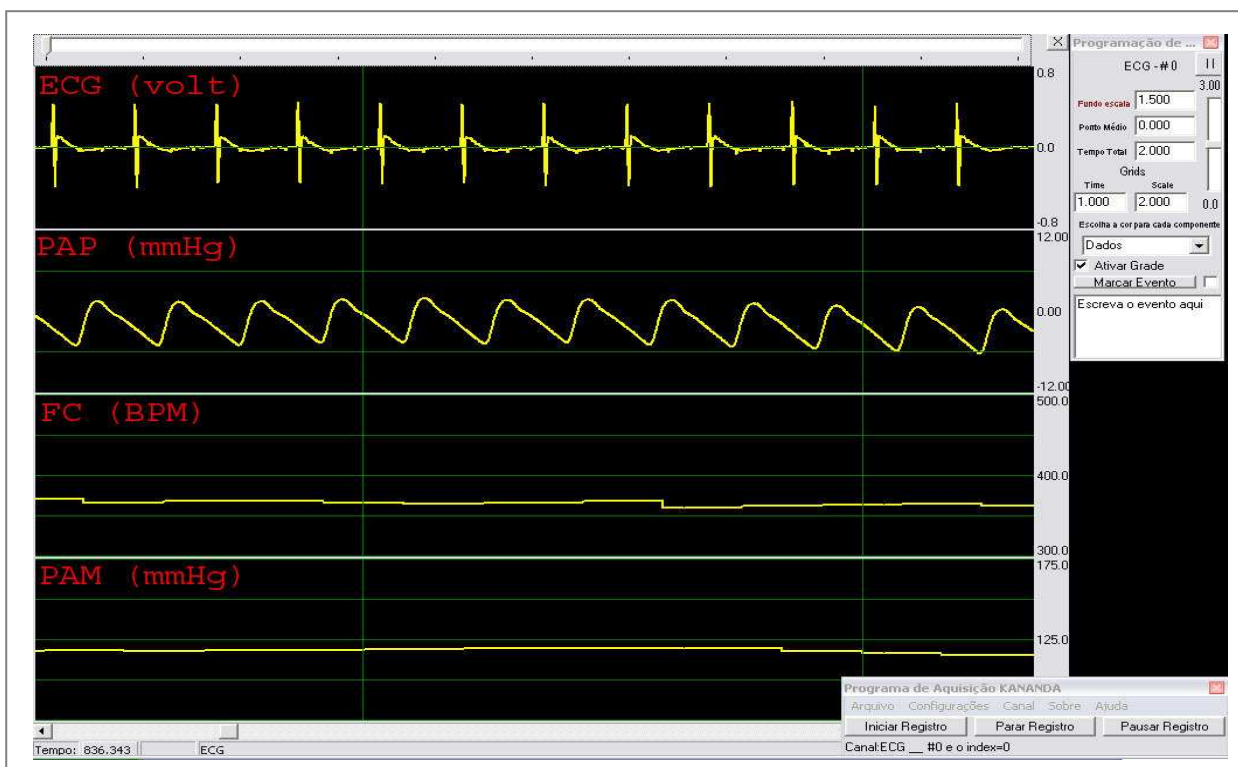
Fig. 4 – Representação da janela de visualização do software Kananda® durante a aquisição eletrocardiográfica e aquisição dos parâmetros cardiovasculares. As linhas representam: eletrocardiograma (1º canal), pressão arterial pulsátil- PAP (2º canal), frequência cardíaca (3º canal) e pressão arterial média (4º canal).
